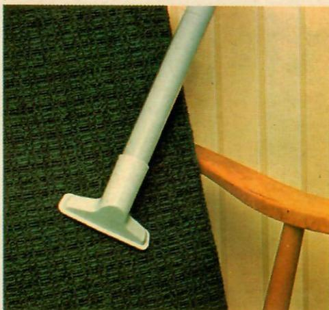
Zachycené nečistoty na kartáčích i na vnitřní ploše hubice vysajete štěrbinovou hubicí. Občas oťfete i povrch pracovních nástavců, na které se nachytá prach vlivem elektrostatického náboje.
