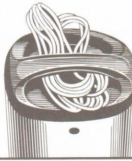
šípky víko uzavřeme (9). Správné uzavření signalizuje klapnutí závěru. Vysavač lze použít i bez vloženého papírového filtru, aniž by se snížila jeho sací schopnost.
